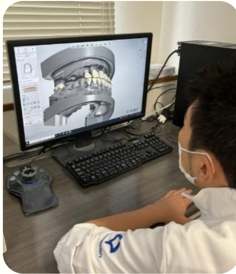
CAD で陶材焼付金属冠のワックスフレームをデザイン中の常藤主任 (歯冠班・実習指導担当)
